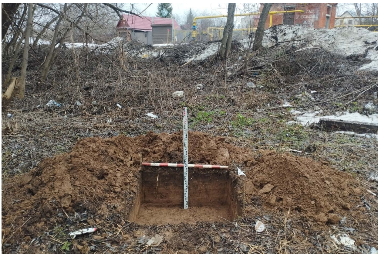
Илл. 26. «Строительство моста через р. Нокса по ул. Черемшанова в ж.м. Вознесенское Советского района г. Казани Республики Татарстан». Общий вид шурфа 2 на уровне грунтовых вод. Вид с юга.
